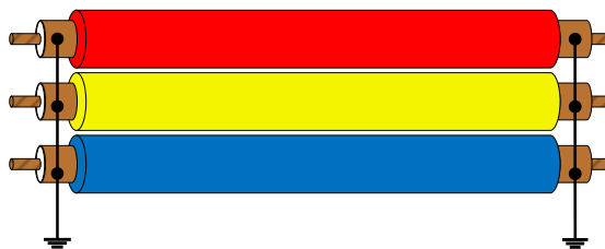
شکل ۱: آرایش اتصال دوطرفه پوشش محافظ کابل به زمین
